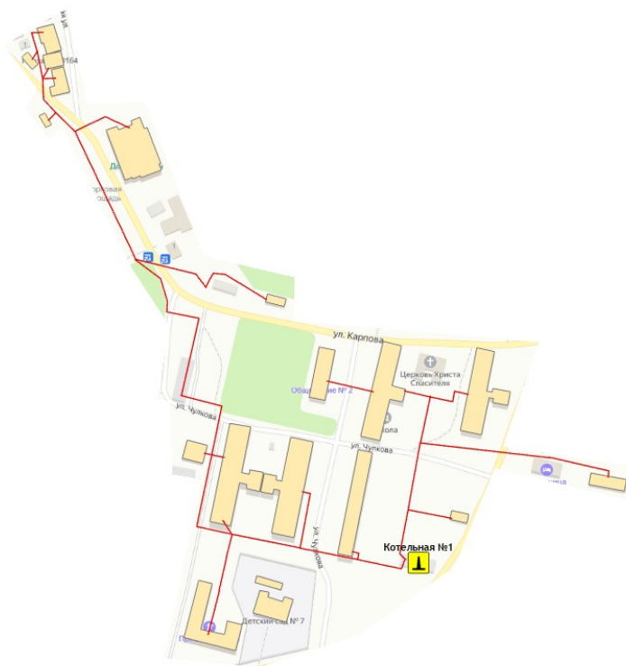
Рисунок 7.7.1 - Изменение зоны действия системы теплоснабжения котельной №1
