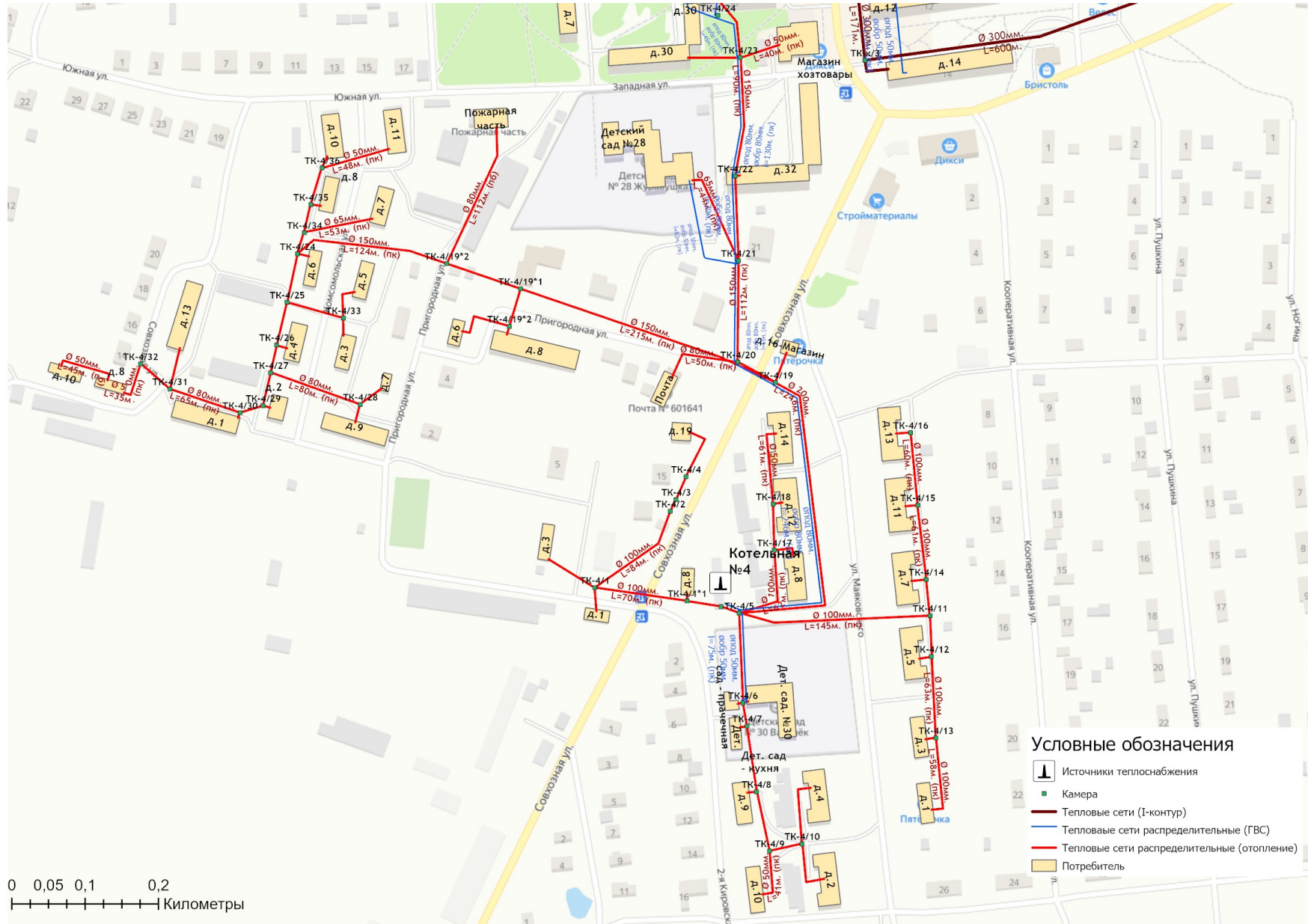
Рисунок 1.3.1.4 - Схема тепловой сети котельной №4
